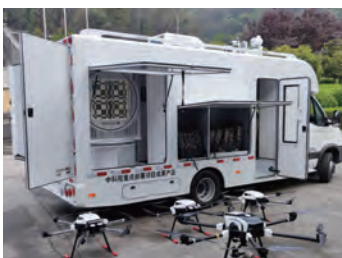
① 编码、康普顿成像系统系列，实现辐射热点实时成像 ② 车载辐射应急监测系统，快速重构大范围区域辐射分布图像
